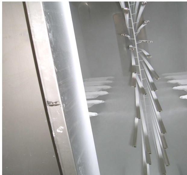
Figura 15. Aplicación de Pintura
