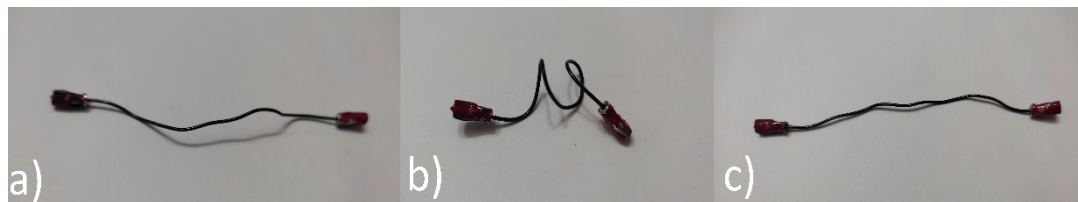
Figura 1: En (a) se observa el cable de Nitinol antes de ser calentado, (b) es el cable calentado y en la forma de prueba, y (c) se muestra el cable estirado manualmente listo para recuperar la forma mostrada en el paso anterior.
