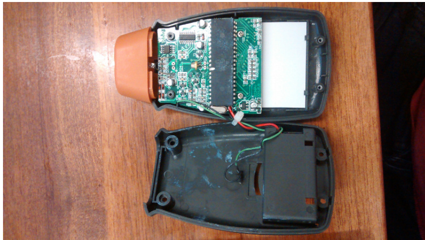
Figura 3.3: Cableado de salida de la señal.
