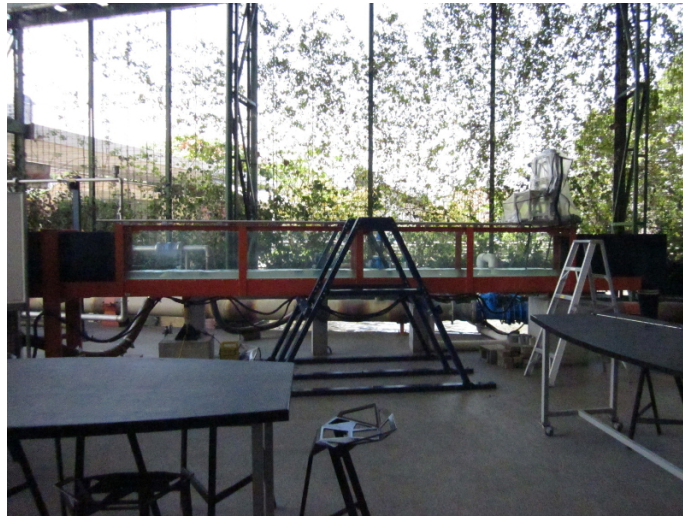
Figura 1.3: Canal abierto de pendiente variable.
