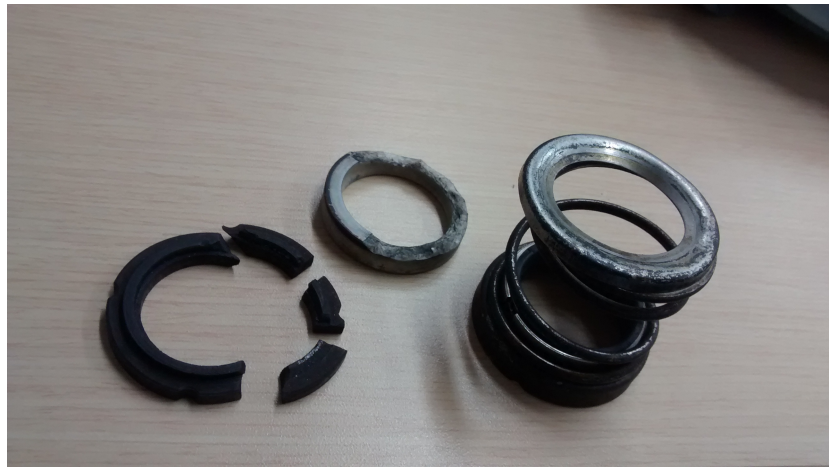
Figura 6.8: Fractura sello mecánico.
