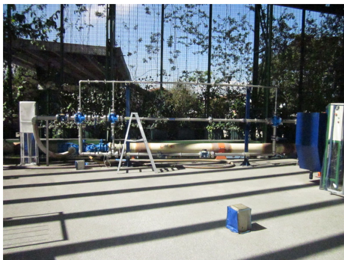
Figura 1.2: Red de Pérdidas en Accesorios y Tuberías.
