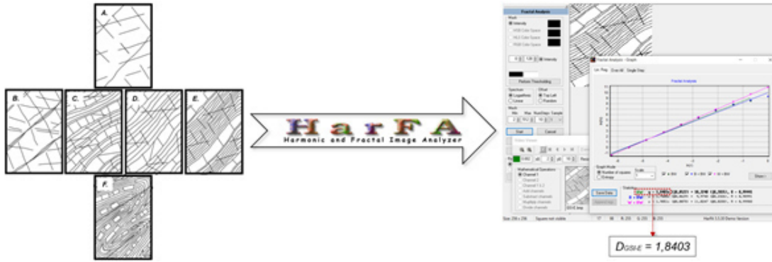
Figura 4.1.4: Estimación de la dimensión fractal (DF) para macizos rocosos heterogéneos como Flysch., Modificado de Hoek & Marinos (2000)
