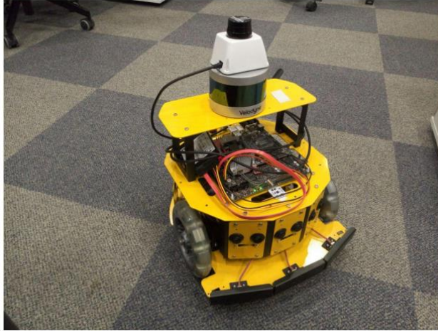
Ilustración 9-Diseño de robot implementado para SLAM LiDAR-based
