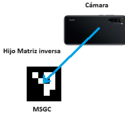
Ilustración 91-Transformación de cámara con respecto a marcador sistema global
