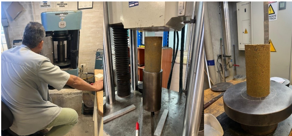
Figura 6. Proceso fabricación de probetas a diferentes grados de saturación del SGGNL investigados. Fuente: Propia
