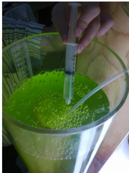
Figura 6.2: Toma de muestra en la parte superior de la columna de burbujeo
