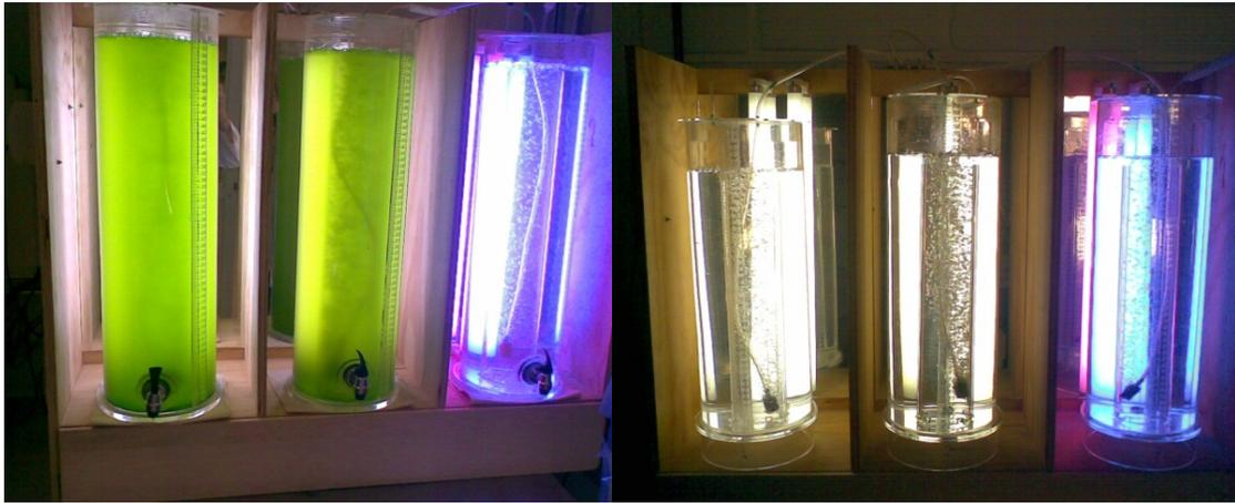
Figura 6.1: Iluminación de los reactores *airlift*
