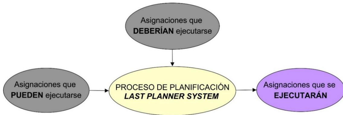
Ilustración 3. Esquema del proceso de planificación del LPS. Adaptado de (H. G. Ballard, 2000)
