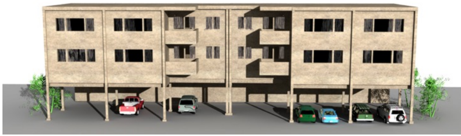
Figura 6. Esquema de configuración estructural con piso débil. Tomado de Los Ángeles Times (2015).
