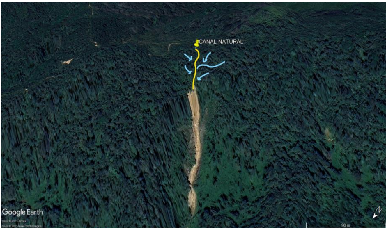
Fig. 23 Trayecto del drenaje.
