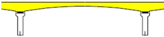
**Figura 15.** Detalle típico de la continuidad de la estructura de los puentes de segunda generación. **Fuente.** SETRA.
