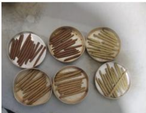
Fotografía 11. Ensayo de Límite Plástico (ASTM) Muestras de suelo preparadas en forma de rollos para ensayo de límite plástico según norma.
