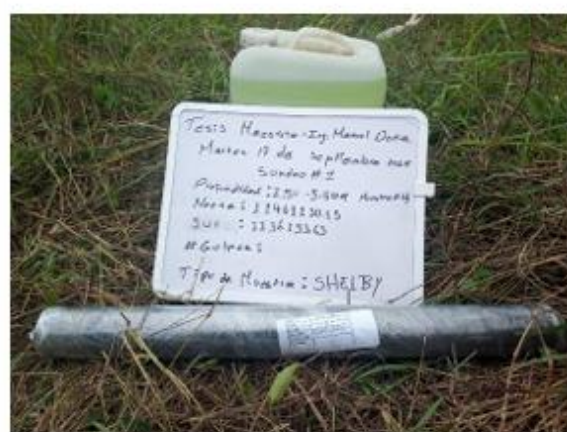
Fotografía 4. Registro de coordenadas y características para Sondeo 1 muestra 4, la cual se encuentra empaquetada para su preservación.
