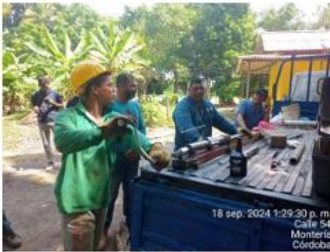
Fotografía 7. Extracción y verificación de muestra en campo: Operarios verifican y etiquetan muestra durante la campaña de perforación, con bitácora y herramientas visibles.
