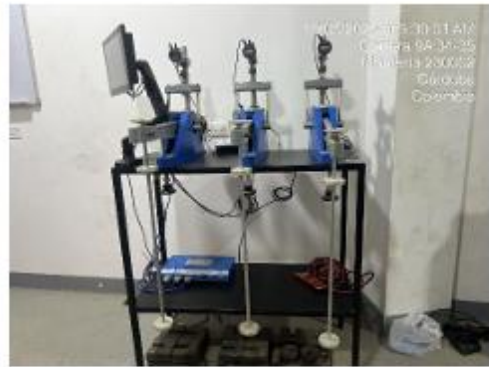
Fotografía 8. Equipo de consolidación unidimensional: Montaje de prueba de consolidación en laboratorio, operativo para ensayo de suelos finos.
