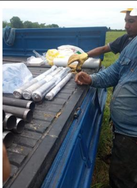
Fotografía 2. Empaque de muestras del Sondeo 1 muestras 1,2,3 y 4, identificación y preservación para ser transportadas al laboratorio, coordenadas norte: 8°45'52.02" y este 75°50'20.41"
