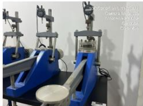
Fotografía 10. Equipo de consolidación usado para desarrollar los ensayos en laboratorio.
