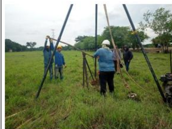
Fotografía 3. Extracción de muestra 1 del sondeo 2 con ensayo SPT, avance a percusión.
