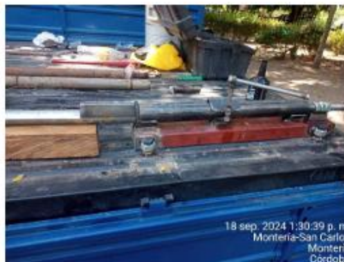
Fotografía 12. Muestras almacenadas post-sondeo. Visualización de muestras rotuladas y tubos Shelby, tras finalización del sondeo.
