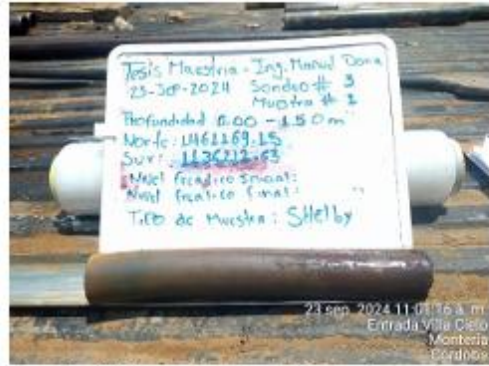
Fotografía 6. Muestra Shelby del Sondeo 3 a profundidad entre 0.00 – 1.50 m, con coordenadas UTM registradas.
