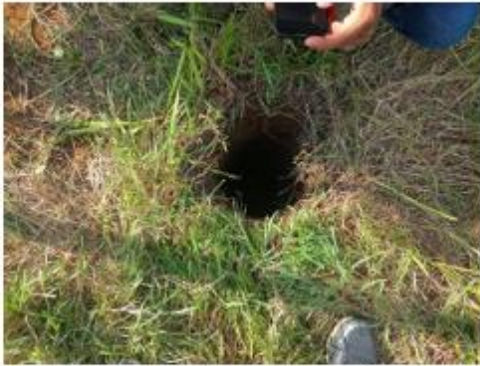
Fotografía 5. Se realiza sondeo a percusión con avance manual, extrayendo muestra SPT en campo abierto Sondeo 2 orificio final.
