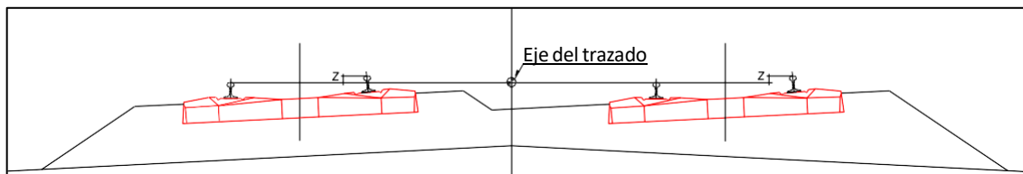
Ilustración 8, diagrama de vía doble con peralte, [11]
