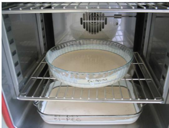
Figura 10: Fotografía del secado de la mezcla Oxido de Zinc – Agua – Aditivo en el laboratorio
