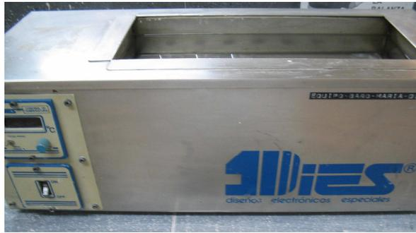
Figura 17: Equipo de baño maría empleado para la prueba de absorción.
