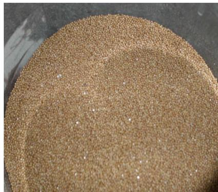
Figura 9. a), b), c) Fotografías molino de atrición empleado para reducir a polvo la materia prima mediante la rotación de un tambor que contiene bolas zirconio. d) bolas de Zirconio.
