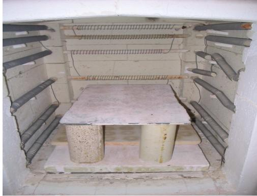
Figura 12: Horno en el cual se lleva a cabo la sinterización de las pastillas cerámicas
