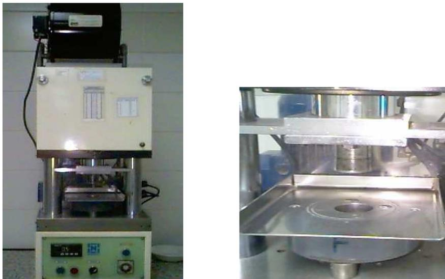
Figura 11: Prensa empleada para la conformación de las pastillas
