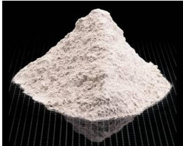
**Figura 6.** Escoria granulada de alto horno. SLAGCEMENT Association.
