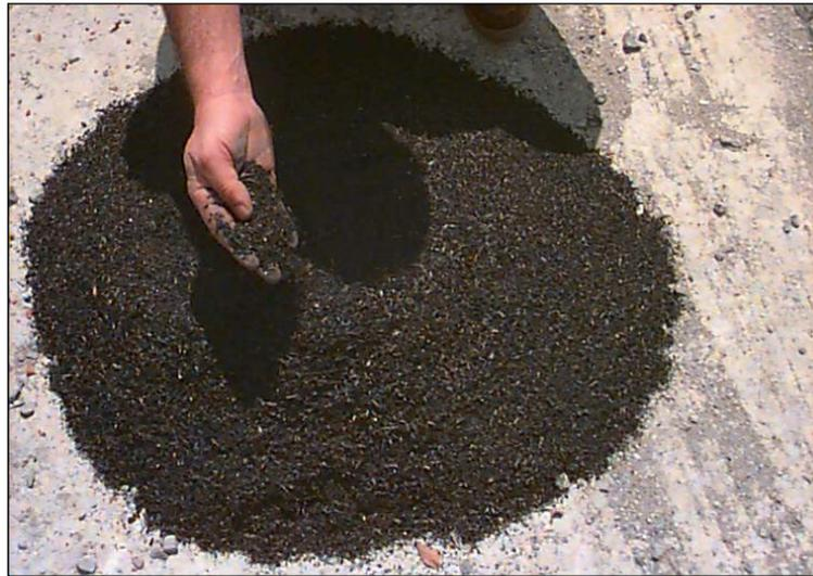
**Figura 9.** Ceniza derivada de la caña de azúcar- ECO-Ingeniería, 2005
