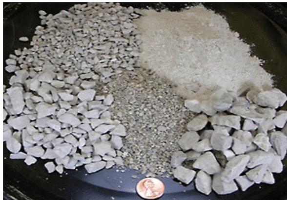
**Figura 10.** Áridos triturados de concreto reciclado.
