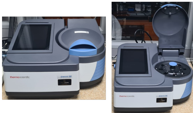
Figura 60: Espectrofotómetro GENESYS TM 150 UV-Vis de la firma Thermo Fisher Scientific con el portador de celdas cerrado (izquierda), y abierto (derecha).
