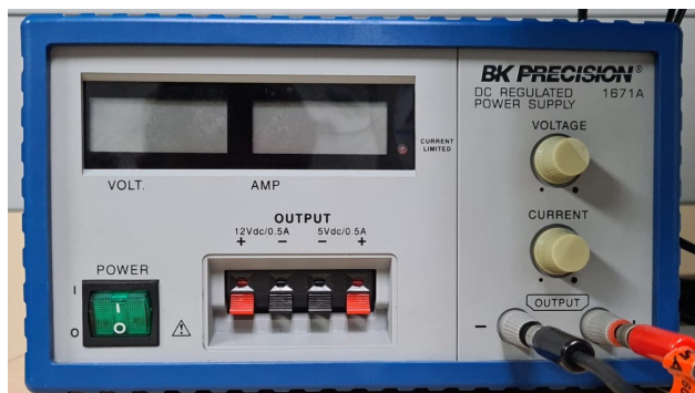
Figura 45: Fuente BK Precision 1671A utilizada para alimentar el transductor de temperatura de fibra óptica Rugged Monitoring.
