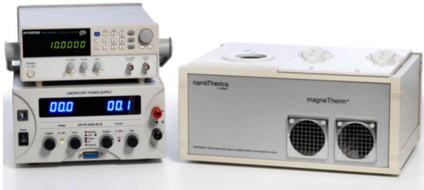
Figura 6: Equipo magneTherm™ de la firma nanoTherics®[32]. El producto básico incluye una fuente de potencia, un generador de onda, un osciloscopio y la etapa calorimétrica.
