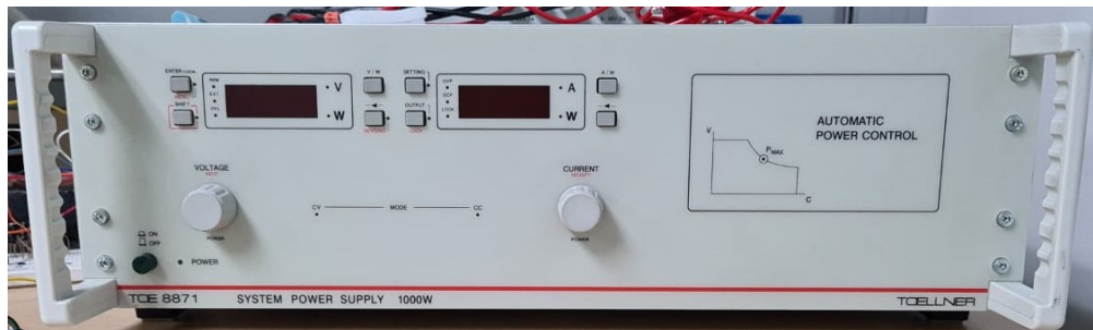
Figura 44: Fuente de alimentación Toellner TOE 8871 – 80 utilizada para alimentar la etapa de actuación del sistema SAR.
