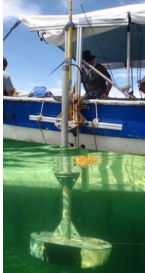
Figura 5. Acople del transductor a la lancha. Foto: J. Prüssmann.
