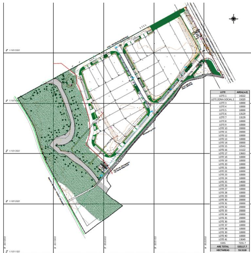
Figura 20: Levantamiento topográfico del proyecto de parque industrial del municipio de Guarne (delimitación de áreas)
