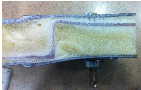
*Ilustración 34: Deformación por apriete de perno (Autoría propia).*
