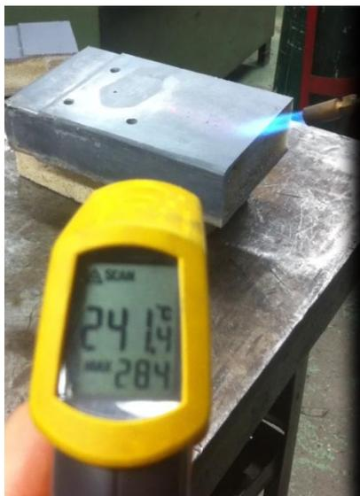
*Ilustración 37: Prueba resistencia a llama (Autoría propia).*
