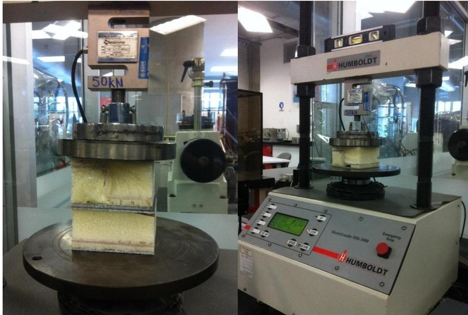
*Ilustración 26: Ensayo a compresión (Autoría propia).*
