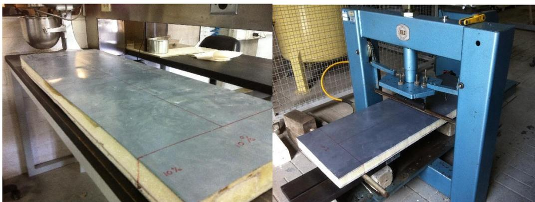
*Ilustración 23: Muestra y ensayo de resistencia a flexión (Autoría propia).*
