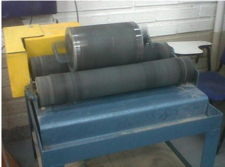
**Figura 27.** Equipo para la Molienda de la ceniza.
