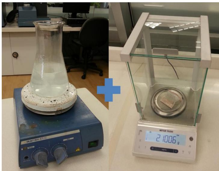
**Figura 39.** A la izquierda se observa la solución saturada de Hidróxido de calcio,  $\text{Ca(OH)}_2$ , y a la derecha la muestra de ceniza (2,10 g).
