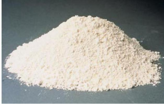
**Figura 6.** La metacaolinita es una arcilla calcinada (IMG. Helmuth, 1987).
