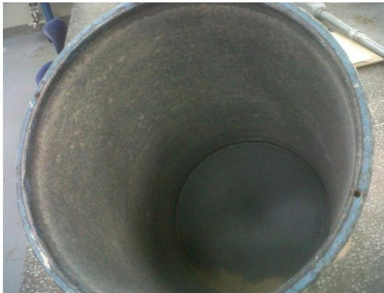
**Figura 28.** Adherencia de la ceniza de hoja de bambú a las paredes del cilindro del molino de bolas.
