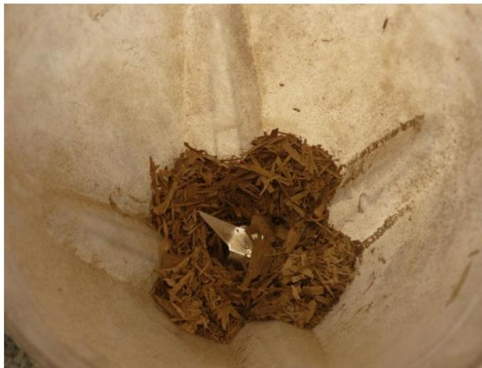
**Figura 23.** Corte de las hojas de bambú secas al sol por medio de espas giratorias.
