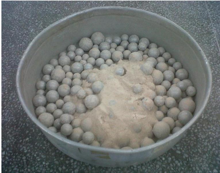
**Figura 29.** Adherencia de la ceniza de hoja de bambú a las bolas de acero del molino.
