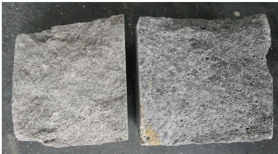
**Figura 46.** Aspecto de un cubo de mortero elaborado con ceniza de hoja de bambú (Cubo a la izquierda de la figura) versus un cubo de mortero elaborado con cemento Portland estructural (Cubo a la derecha de la figura).
