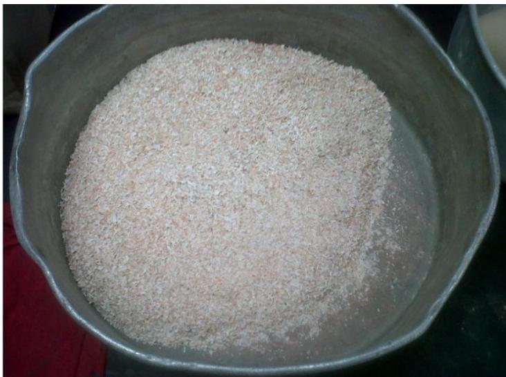
**Figura 26.** Coloración rojiza clara, efecto de la contaminación con polvillo de la pieza cerámica de arcilla cocida.
