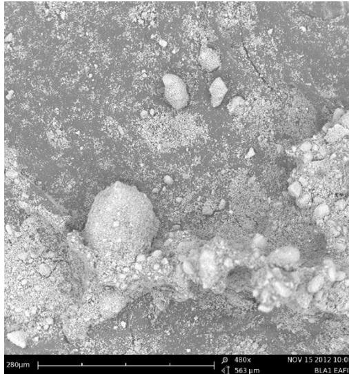
**Figura 38.** Microscopia de barrido electrónico (SEM) - Morfología de la ceniza de hoja de bambú, 480x.
