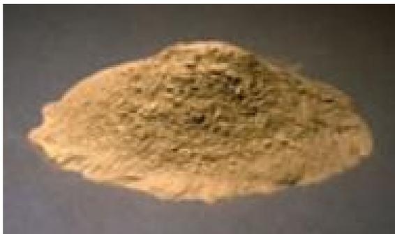
**Figura 9.** La ceniza volante es un polvo que se parece con el cemento y ha sido usada desde los años 30. (IMG Shanghai Xuanshi Machinery Co., Ltd, <http://www.trituradora-de-piedra.net/trituradora-mineral/mill-fly-ash.html>)
