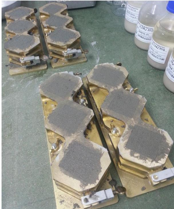
**Figura 44.** Elaboración de los cubos de mortero, en la parte superior de la fotografía se observan los cubos de la mezcla de control y en la parte inferior de la fotografía los cubos de la mezcla de ensayo.
