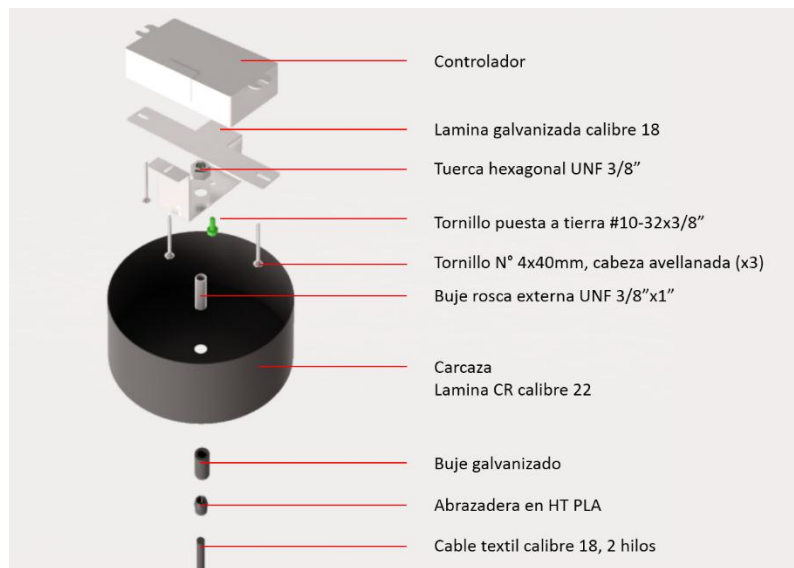
Figura 80. Vista en explosión y detalles del ensamble del subsistema de suspensión. Fuente: Elaboración propia.
