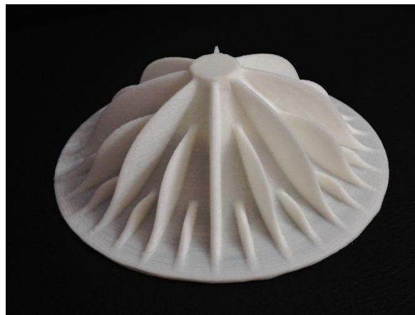
Figura 86. Prototipo a escala del cuerpo de Agarical, impreso en PLA. Fuente: Elaboración propia.
