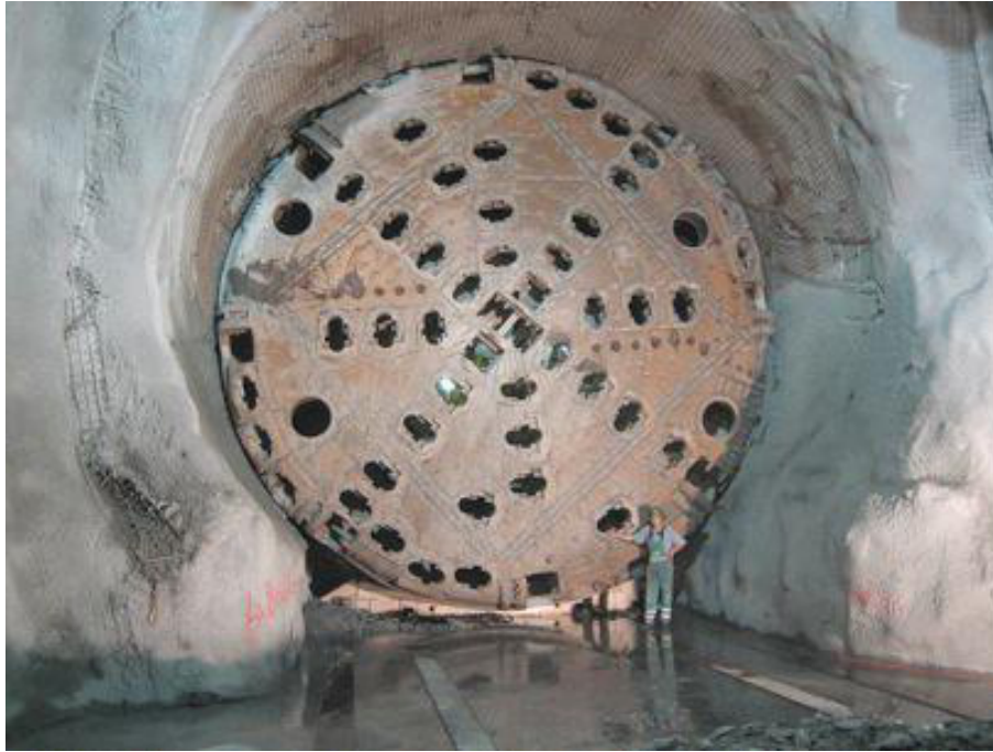
Figura 2.1: TBM S-210 usada en el Gotthard Base - Este. Tomado de Wikipedia. [5]
