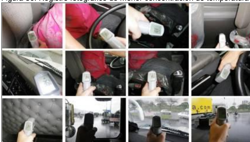
Figura 50. Registro fotográfico de menor concentración de temperatura en cabina- camión
