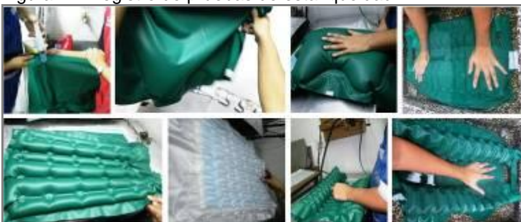
Figura 44. Registro de pruebas de estanqueidad
