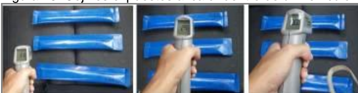
Figura 48. Cojines expuestos al calor dentro de un vehículo
