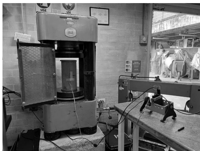
Fig. 3 Ensayo módulo de elasticidad, coeficiente de Poisson
