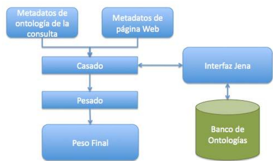
Figura 27. Arquitectura del sub-modulo de casado de ontologías de un motor de búsqueda semántico basado en ontología
