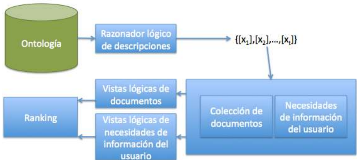
Figura 13. Arquitectura para un modelo de recuperación de información basado en Ontología
