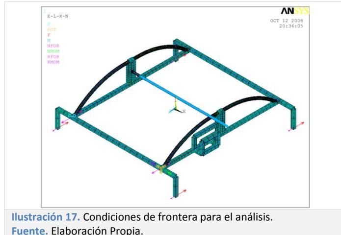
**Ilustración 17.** Condiciones de frontera para el análisis.
