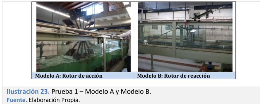
El Modelo A corresponde a un rotor de acción con 66 cm de diámetro y 16 aspas con palas sumergibles en policarbonato de 10 cm<sup>2</sup> de área de arrastre, y el Modelo B corresponde a una propela comercial con un área de arrastre similar.
