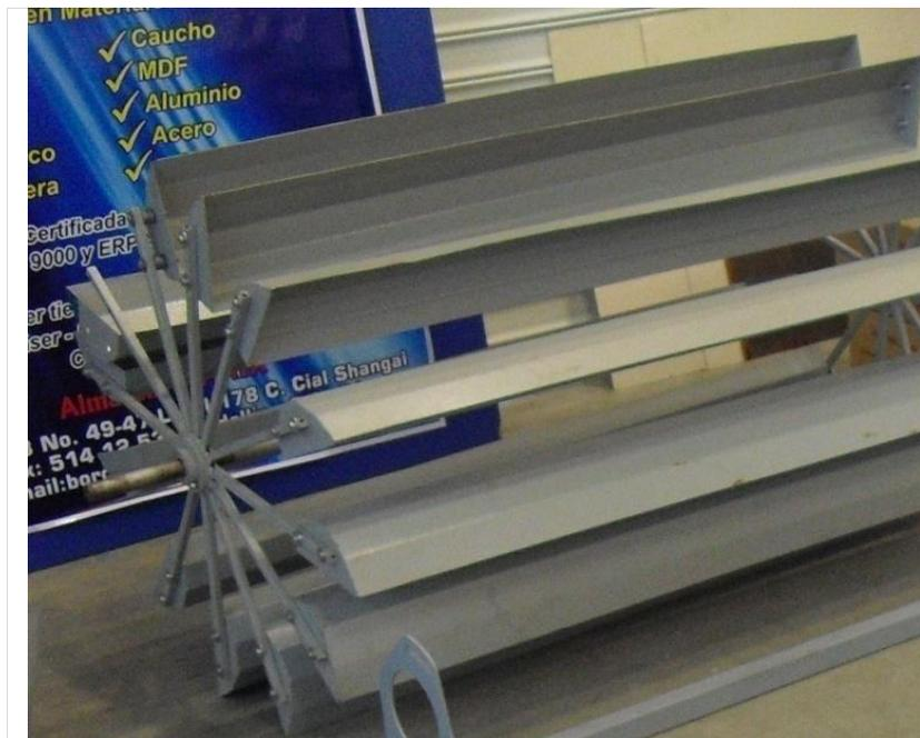
**Ilustración 40.** Modelo funcional del rotor.
