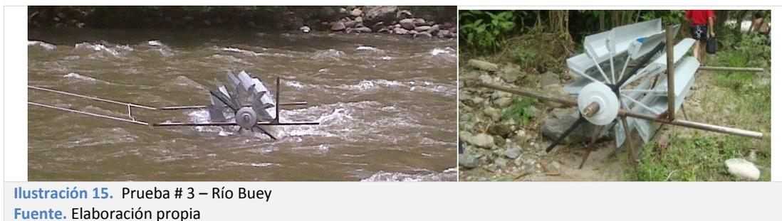
Por otro lado estas pruebas fueron importantes, puesto que permitieron validar el modelo analítico planteado para el rotor, validación que fue necesaria ya que éste modelo consistió en un compendio de diferentes modelos propuestos y no en la aplicación de un modelo específico para este tipo de rotor. Para esto se realizaron comparaciones de lo
