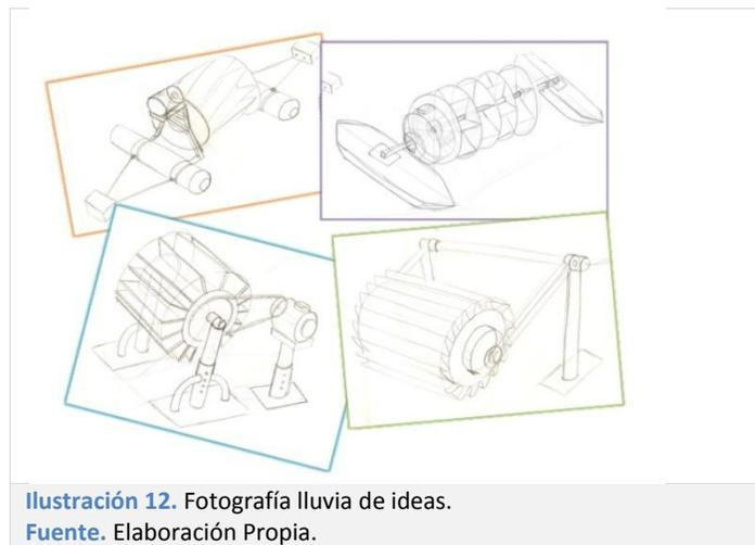
Por otro lado se usó esta herramienta para conceptualizar individualmente los componentes que se diseñaron, y como una primera aproximación al diseño de detalle de los mismos. Se realizaron sesiones con los miembros del equipo de diseño, en donde se generaron y plasmaron ideas para el diseño de componentes como el rotor y los pontones. En estas se exploraron aspectos como:
