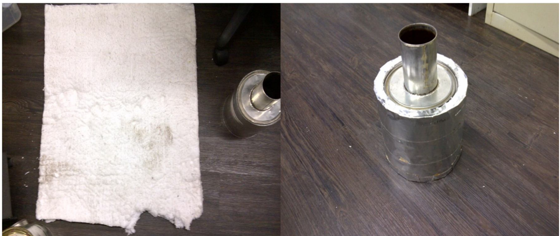
Ilustración 43. Cámara recubierta con el aislante
