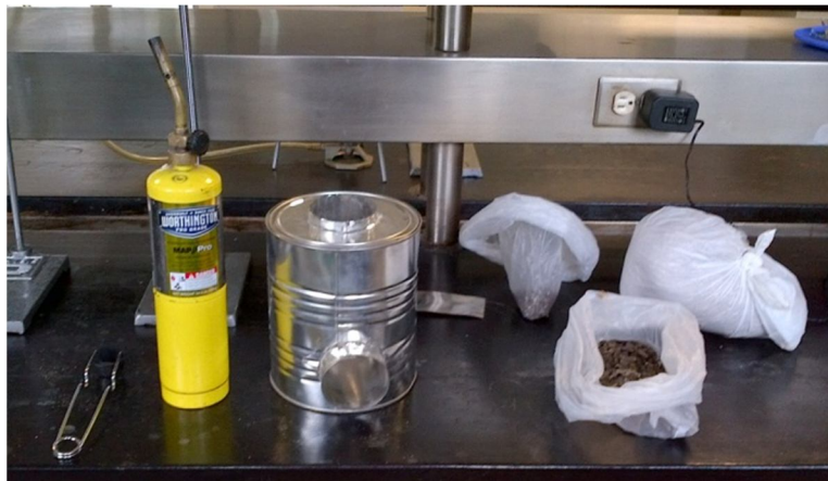
Ilustración 34. Elementos utilizados prueba de quema en el combustor
