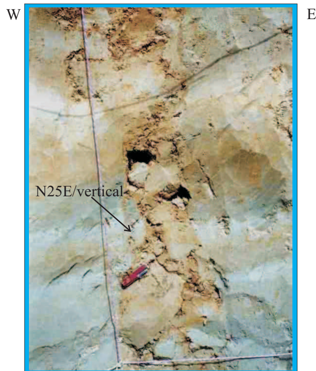
Figura 54: Estación CPL58, sector Filandia. Extremo oriental del corte. Se aprecia la secuencia de cenizas volcánicas de caída afectadas por agrietamientos característicos de un ambiente distensivo (ver esquema paleosísmico, Figura 56)
