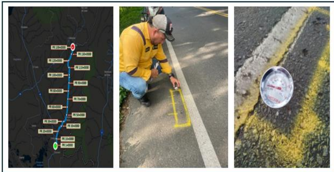
Figura 1: Toma de temperatura en campo.
