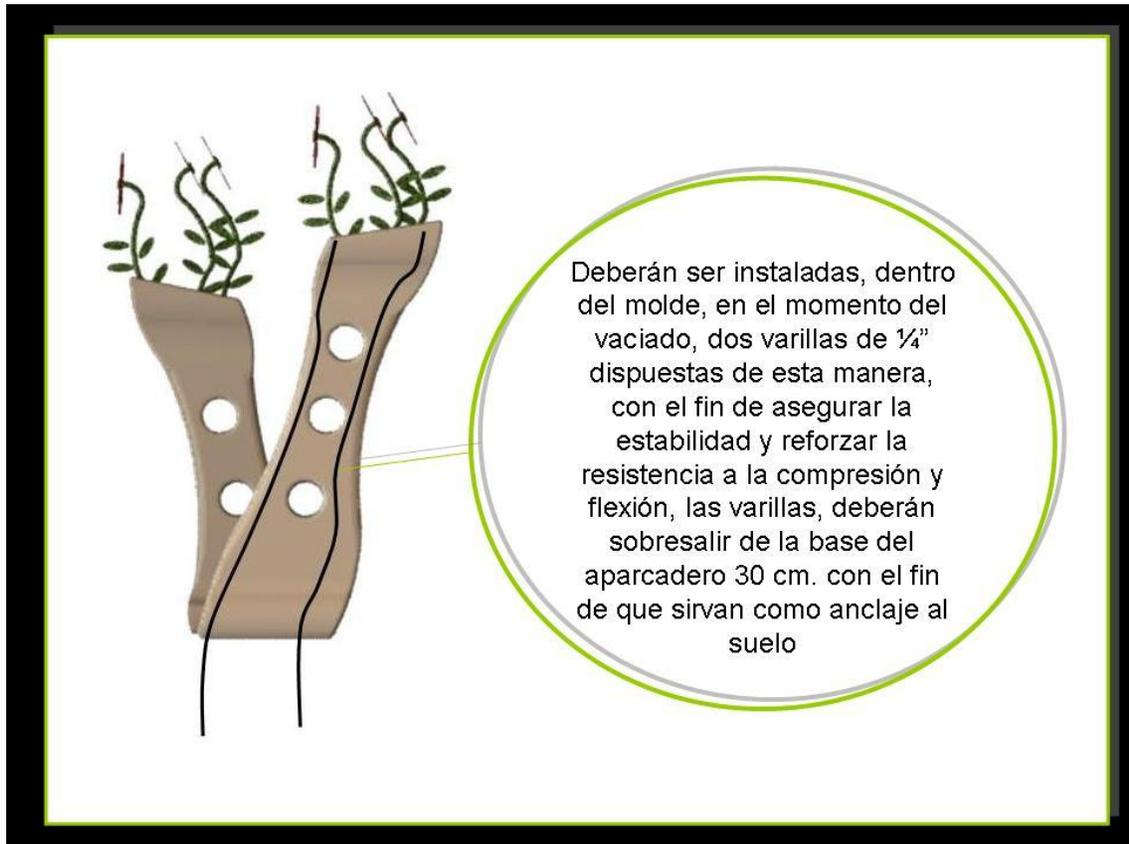
Deberá hacerse una perforación de 30 cm. de ancho \* 30cm largo \* 40cm de profundidad, en el cual se deberá vaciar 10 Kg. de cemento reciclado que servirá de unión entre el suelo y las varillas del sistema.
