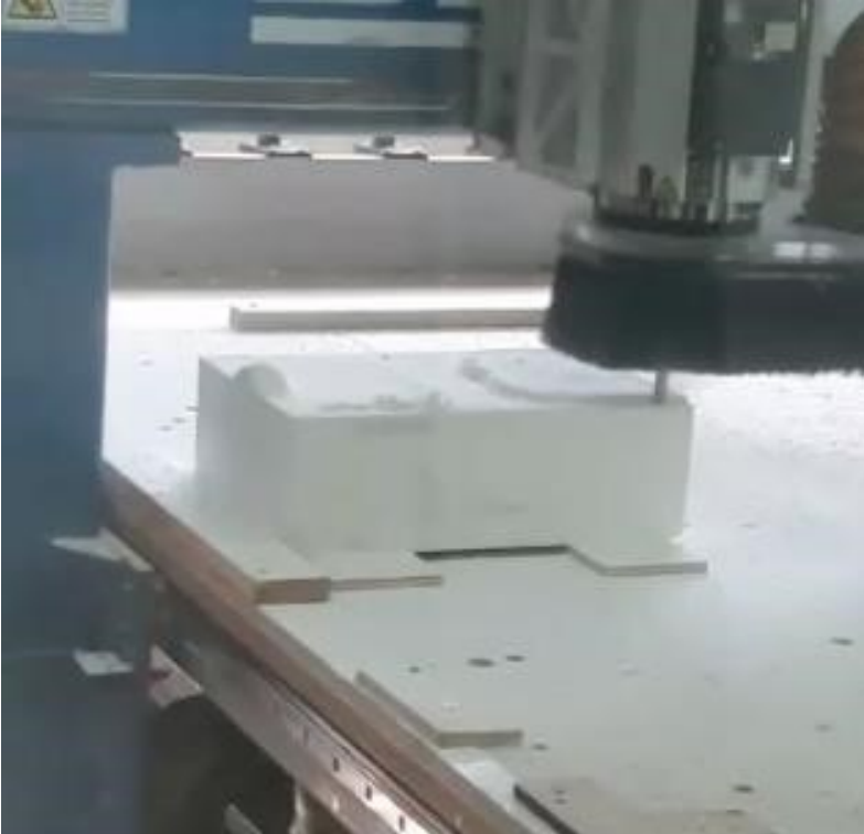
Imagen 24 Proceso de mecanizado de bloques de yeso.
