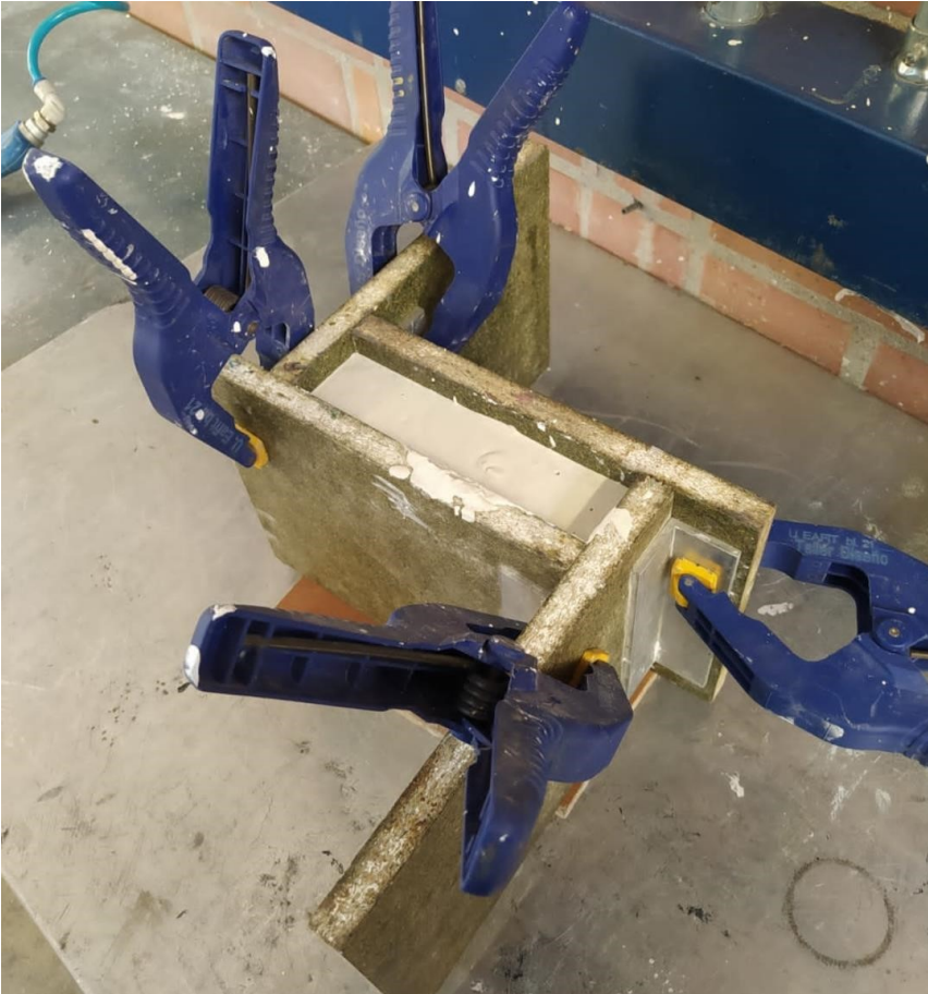
Imagen 11 Vaciado de segunda cavidad, sobre mesa vibradora.
