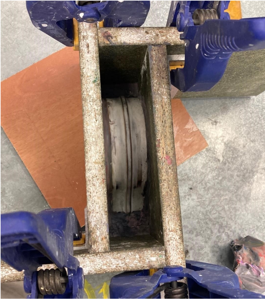
Imagen 9 Matriz de moldeo y cama de moldeo en la caja para vaciado.
