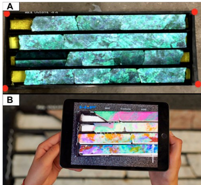
Figura 6. Escaneo hiperespectral de núcleos de perforación con realidad aumentada.
