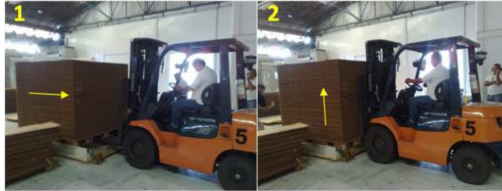
Figura 102. Manipulación del montacargas en la estiba de papel tipo sencilla.
