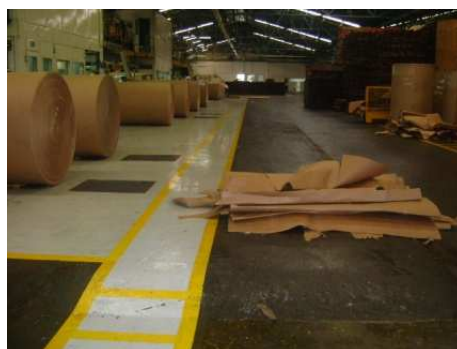
Figura 64. Láminas de Desperdicio de Papel generadas Luego de la Preparacion del Rollo de Papel.
