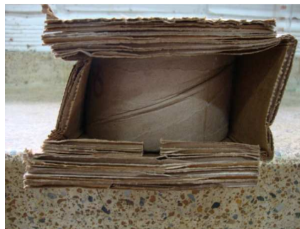
Figura 117. Lugar de falla en la muestra # 3.
