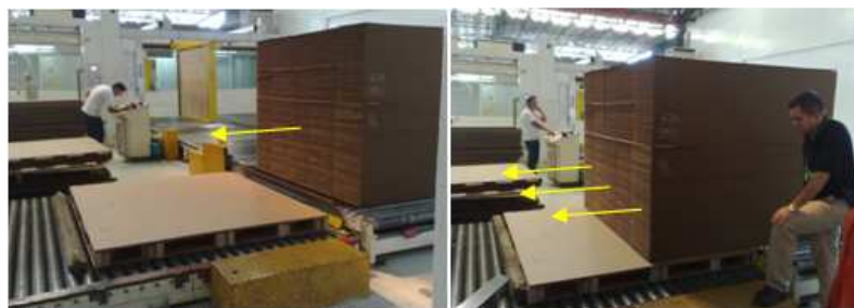
Figura 101. Desplazamiento de las láminas de cartón sobre la estiba.
