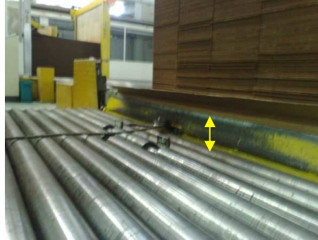
Figura 58. Nivel Entre los Dos transportadores de Rodillos. Empujador del Sistema Apilador.
