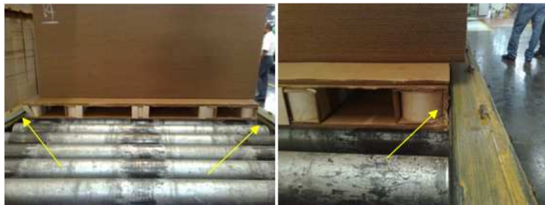
Figura 105. Problema entre el tren alimentador de la flexo 37 y la estiba de papel tipo sencilla.
