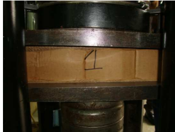
Figura 113. Muestra # 1 en el momento que finaliza en ensayo.
