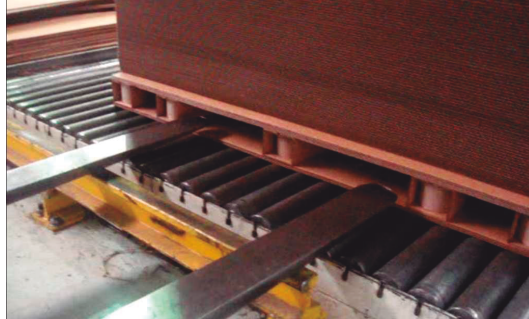
Figura 100. Entrada de las uñas del montacargas en la estiba de papel.
