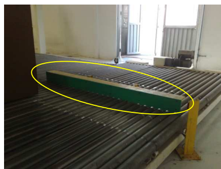
Figura 57. Empujador del Sistema Apilador.
