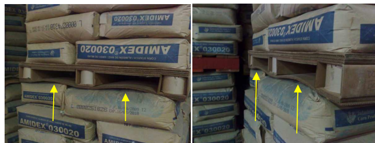
Figura 90. Deformación de la plataforma inferior de la estiba de papel para almidón.
