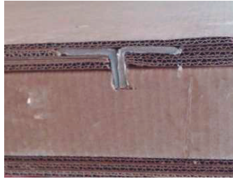
Figura 87. Refuerzo de esquineros en la plataforma superior.
