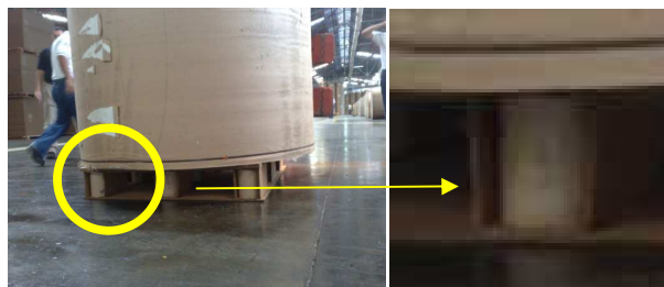
Figura 81. Aplastamiento de core del diseño 1 de estiba de papel.
