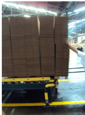
Figura 127. Daño ocasionado por el posicionamiento de la estiba en el transportador de rodillos.
