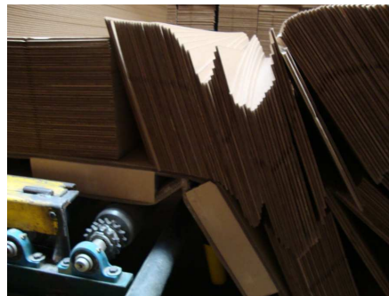
Figura 129. Fractura de la estiba en el momento de la devolución del tren alimentador.
