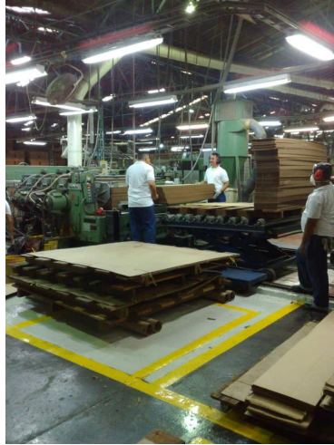
Figura 61. Alimentación de la Máquina Flexográfica.
