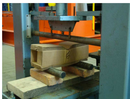
Figura 122. Muestra # 6 momentos después de sufrir su máxima resistencia a la flexión (4445 N).
