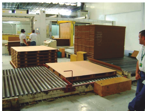
Figura 28. Sistema Apilador de la Fábrica de Cajas de C.I. Unibán S.A.
