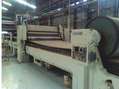
Figura 22. Plancha de Secado de la Fábrica de Cajas de C.I. Unibán S.A.
