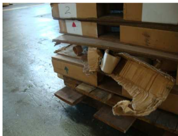
Figura 128. Daño ocasionado por el maltrato de las platinas de las guardas metalizas en el transportador de rodillos.
