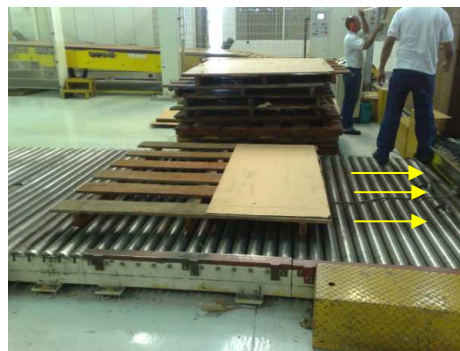
Figura 55.Desplazamiento de la Estiba por el Colchón de Rodillos.
