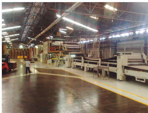
Figura 16. Máquina corrugadora de la Fábrica de Cajas de C.I. Unibán S.A.
