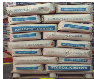
Figura 88. Estiba de papel cargada con 40 bultos de almidón (1000Kg).
