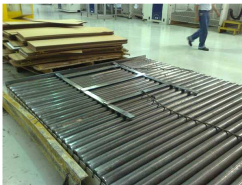
Figura 53. Dispositivo Metálico Usado para Depositar la Estiba de Madera.
