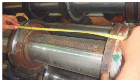
Figura 35. Cuchillas del Cuerpo Ranurador.
