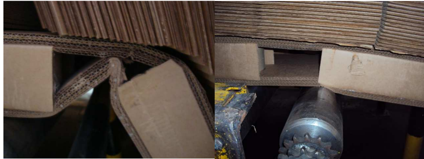
Figura 132. Comparación del comportamiento de la estiba del diseño anterior y el diseño propuesto actualmente.
