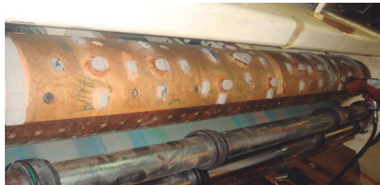
Figura 36. Troquel montado en el cilindro del cuerpo troquelador.
