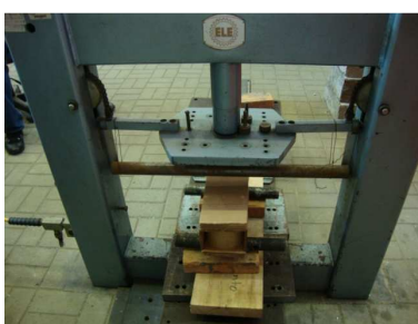
Figura 119. Marco de flexión de prensa hidráulica ELE con muestra. Ilustración de la longitud de luz tomada para la realización de los ensayos (en el interior de la muestra).
