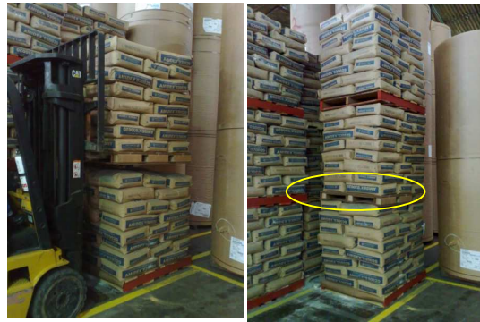
Figura 89. Ubicación de la estiba de papel para almidón en la segunda posición de un arrume de tres estibas.
