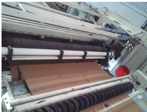
Figura 23. Máquina Cortadora y Hendedora Longitudinal de la Fábrica de Cajas de C.I. Unibán S.A.
