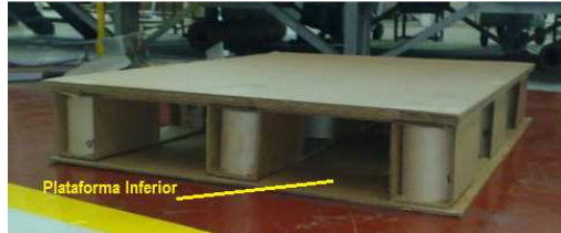
Figura 80. Plataforma inferior del diseño 1 de estiba de papel.
