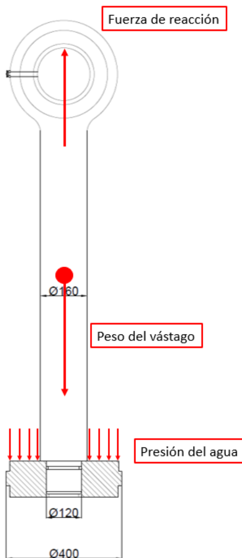
Figura 43. Diagrama de cuerpo libre Caso a tracción – Vástago servomotor
