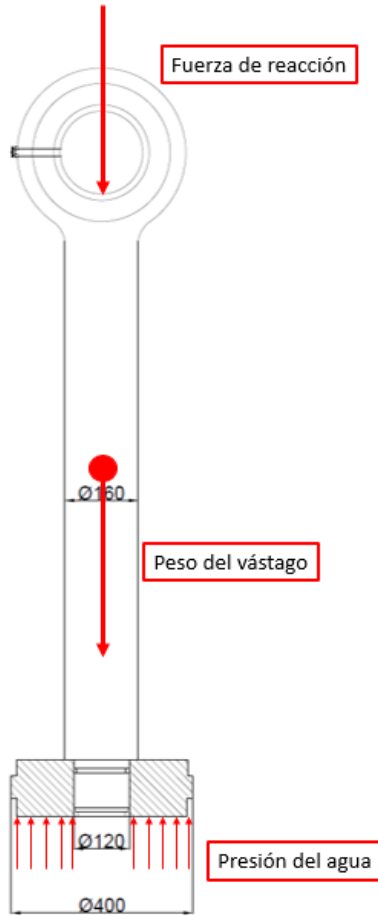
Figura 44. Diagrama de cuerpo libre – Caso a compresión – Vástago servomotor
