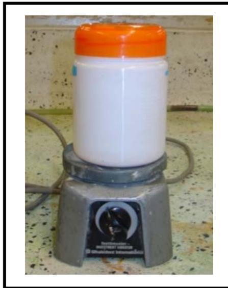
**Figura 45:** Proceso de desaireación.
