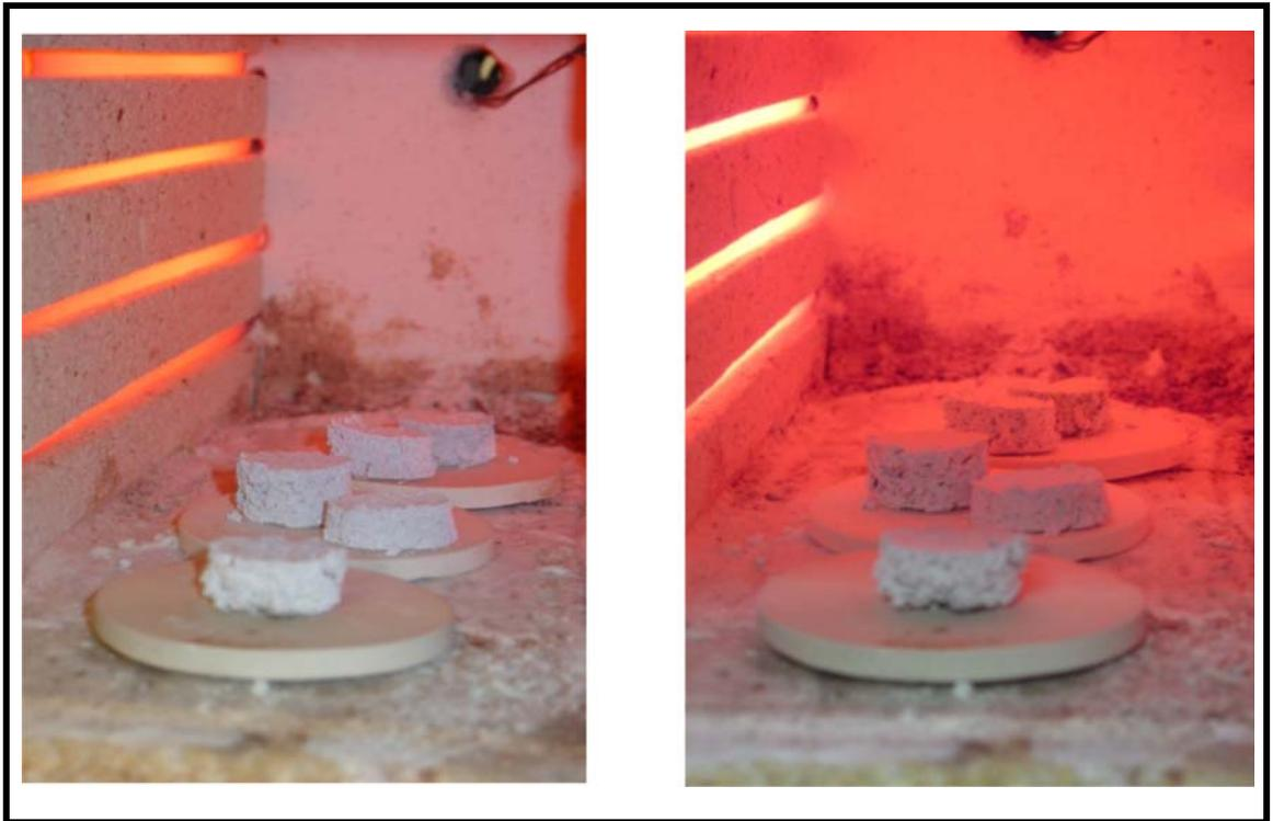
**Figura 47:** Espumas durante el proceso de sinterización.
