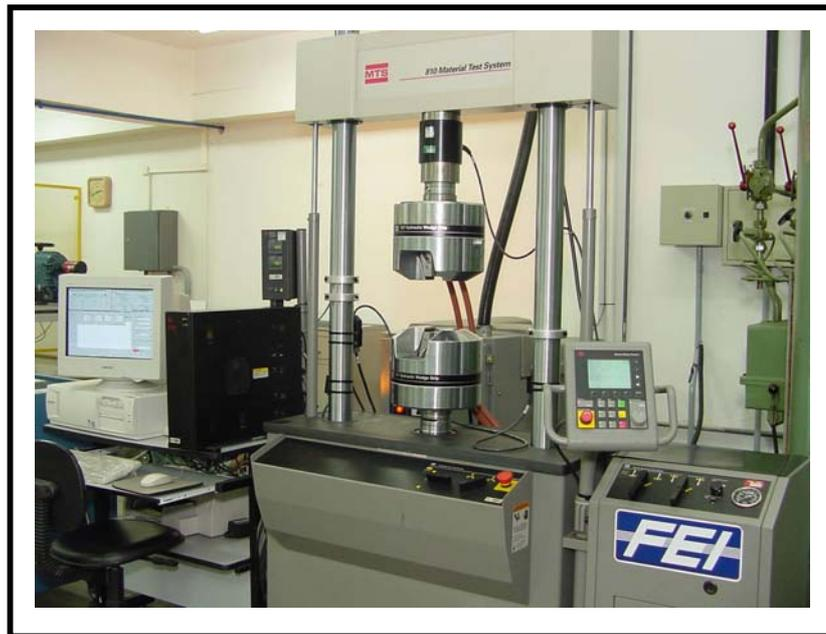
**Figura 33:** Máquina universal de ensayos mecánicos<sup>74</sup>.
