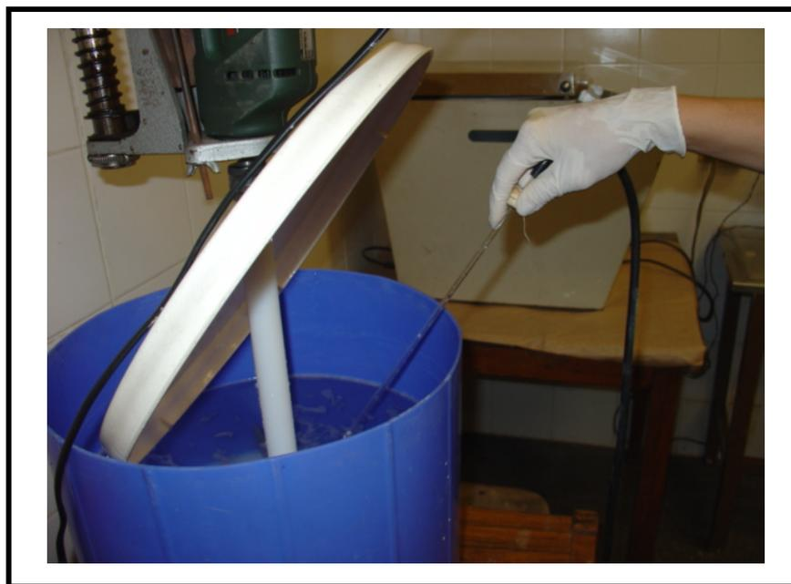
**Figura 39:** Por medio de una manguera y presión se retira el exceso de H<sub>2</sub>O para aislar la HA.
