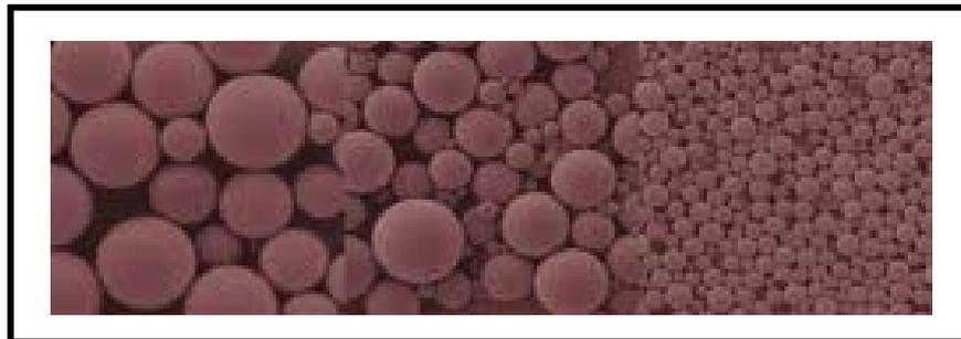
**Figura 2:** Microscopía electrónica de microesferas de biopolímeros<sup>15</sup>.
