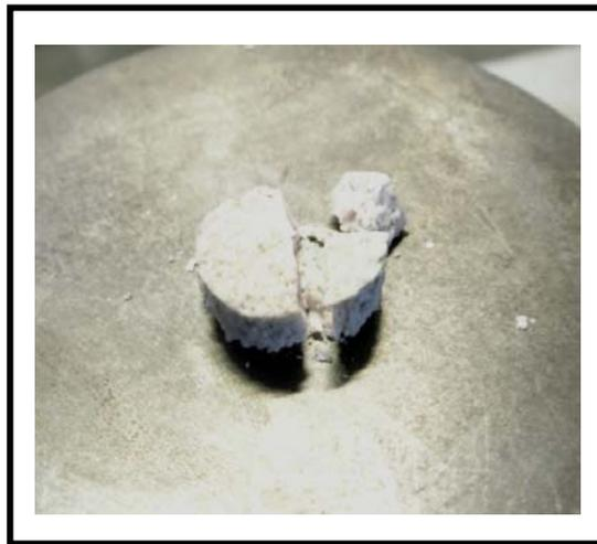
**Figura 77:** Probeta de espumas de HA con el 40% de sólidos sometida a fuerzas de compresión.
