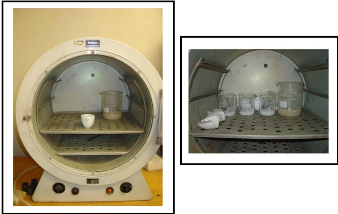
**Figura 41:** Dentro del horno se ubican varios recipientes entre beakers y crisoles para secar simultáneamente toda la HA.
