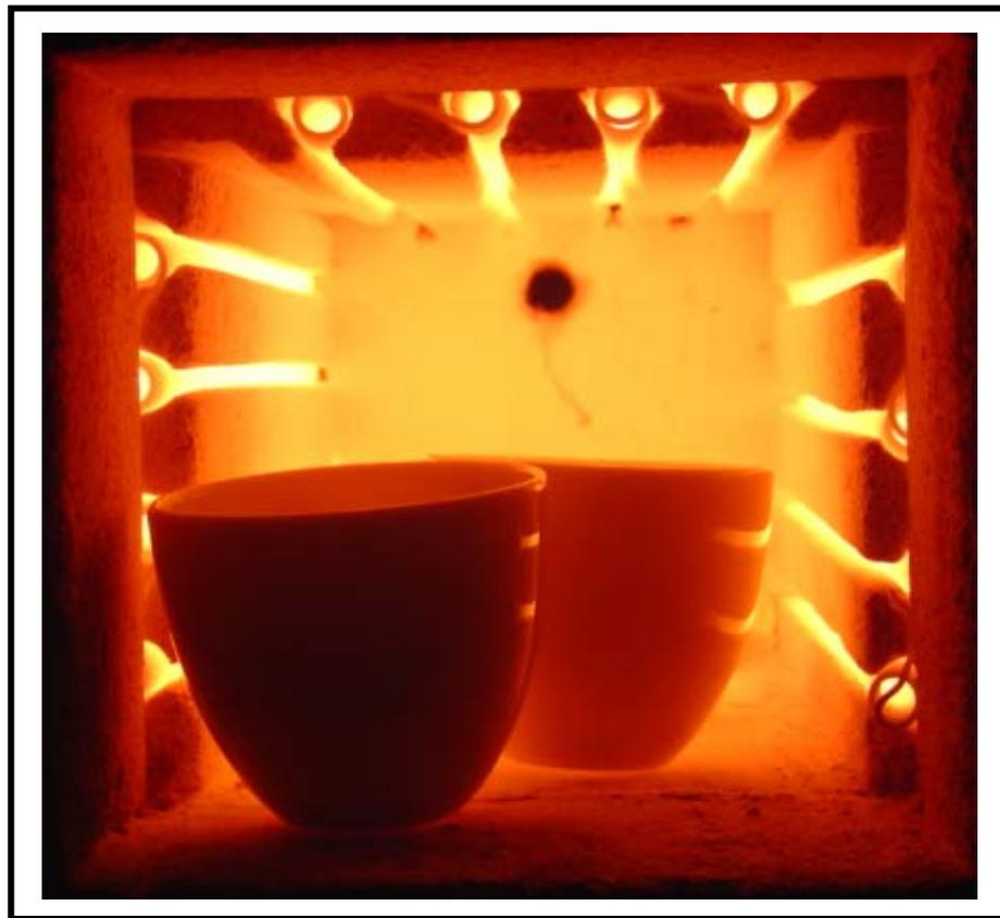
**Figura 42:** Sinterización a 1050 °C.
