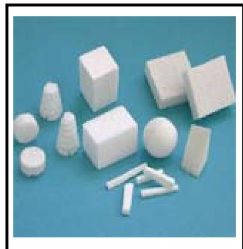
**Figura 11:** Gránulos y bloques de Hidroxiapatita<sup>40</sup>.
