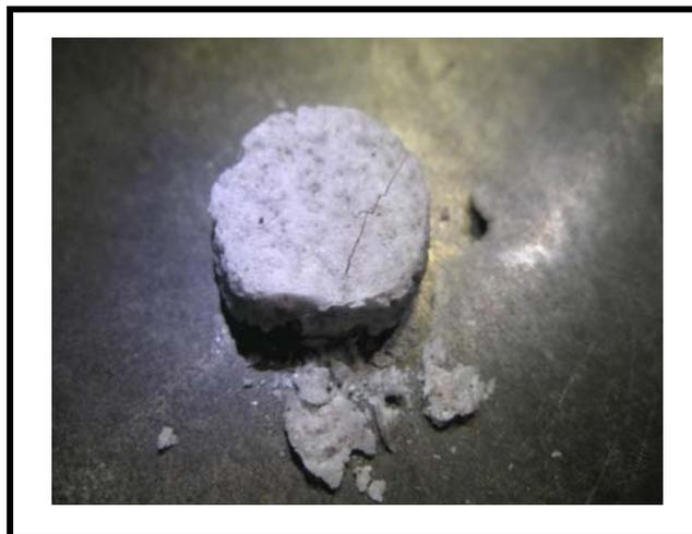
**Figura 76:** Probeta de espumas de HA con el 50% de sólidos sometida a fuerzas de compresión.
