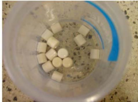
Contenedor con esferas de Alúmina que permiten homogeneizar la mezcla en el proceso de agitación
