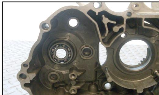
Introduzca inicialmente el tornillo con un disco por el orificio de la balinera.
