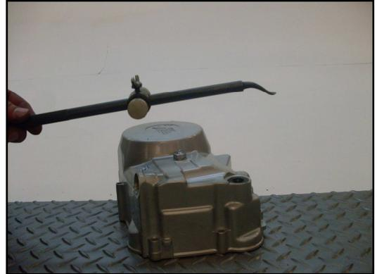
Ubique la punta del extractor en la parte interna del retenedor y aplique una leve fuerza en el extremo opuesto de la barra.
