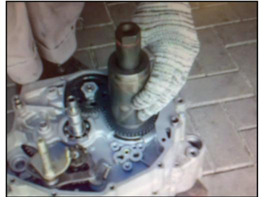
Sostenga el piñón primario usando los dos semi-bujes.
