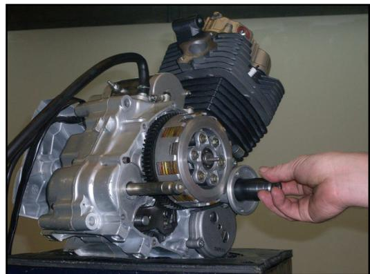
Utilizando el sostenedor de volante, restrinja el movimiento de esta y proceda a desapretar la copa con la herramienta adecuada.
