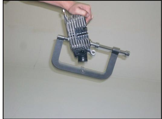
Ajuste manualmente la prensa en la culata de la motocicleta.
