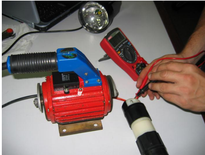
Ilustración 9. Toma de Voltaje
