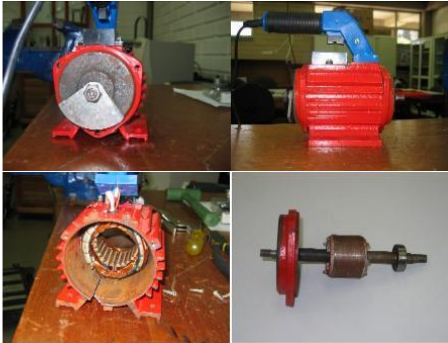
Ilustración 1. Despiece del Motovibrador
