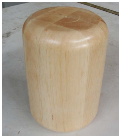
Figura 7. Modelo fabricado en madera para la creación del molde por laminado manual de fibra de vidrio. Fuente: El autor.
