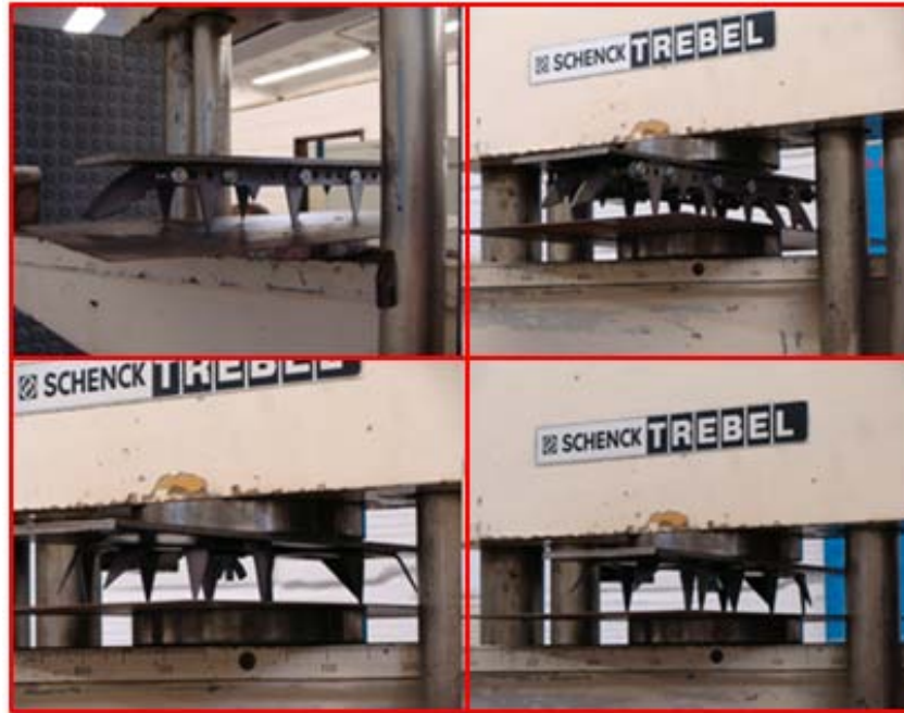
Ilustración 39. Prueba estática de compresión en la Universal
