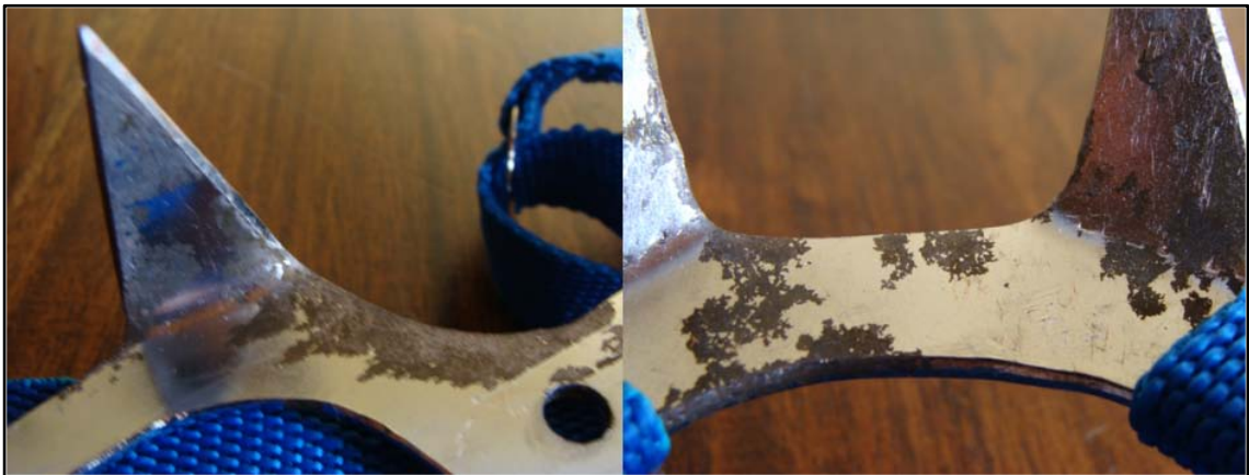
Ilustración 49. Desgaste del cromado
