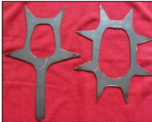
Ilustración 30. Prototipo 1 después del corte por plasma
