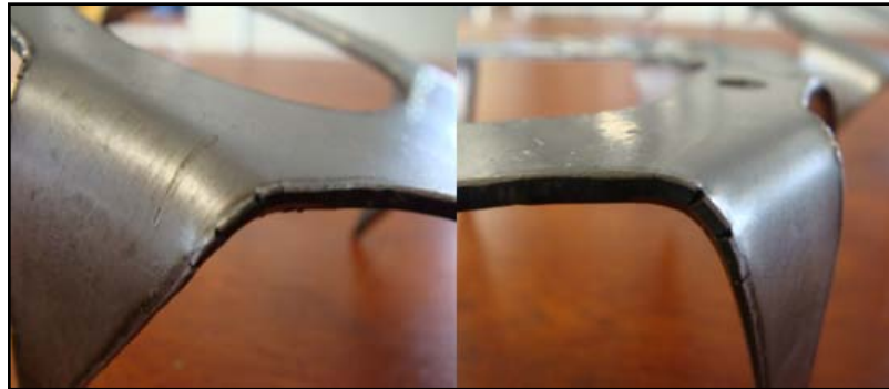
Ilustración 31. Fracturas generadas por el doblado del material
