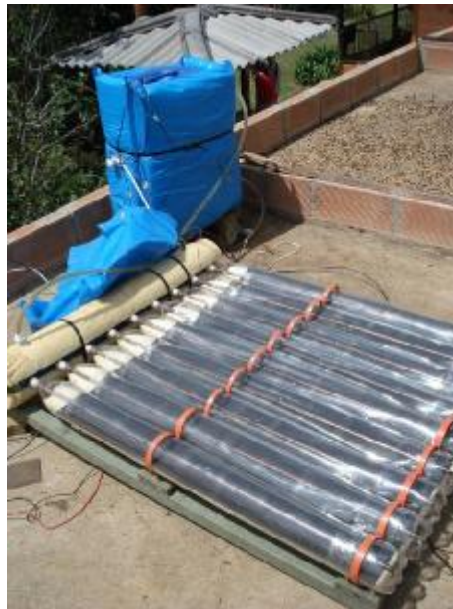
Ilustración 34 Pérdida de estabilidad dimensional de las cubiertas individuales
