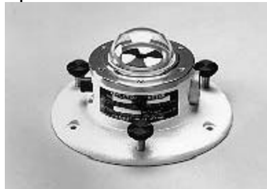
Ilustración 9 Esquema de un piranómetro
