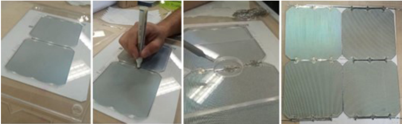
Figura 3.4. Interconexión de celdas fotovoltaicas
