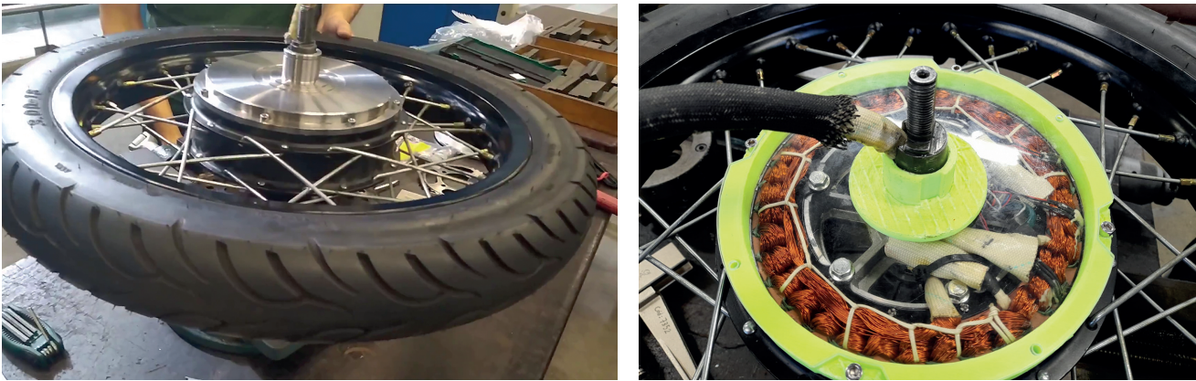
Figura 2.13. Motor BLDC en configuración HUB en una motocicleta
