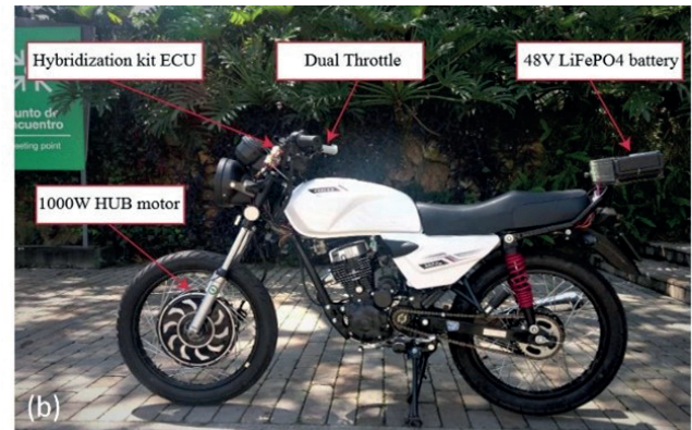
Figura 6.1. (a) Esquema arquitectura 1. (b) Prototipo arquitectura 1
