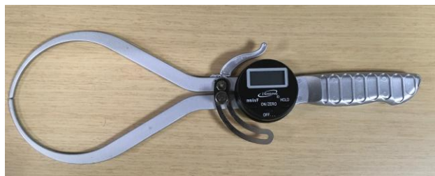
Figura 23. Medidor de espesor empleado en la medición del espesor de las láminas
