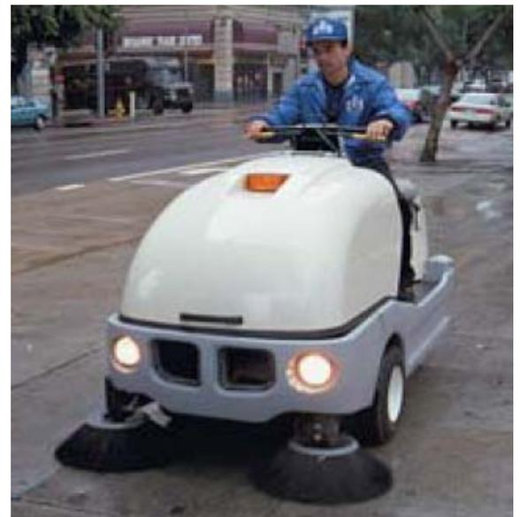
Control de apagado del aspirador, tolva de residuos resistente a la corrosión, Sistema de giro con control de velocidad
