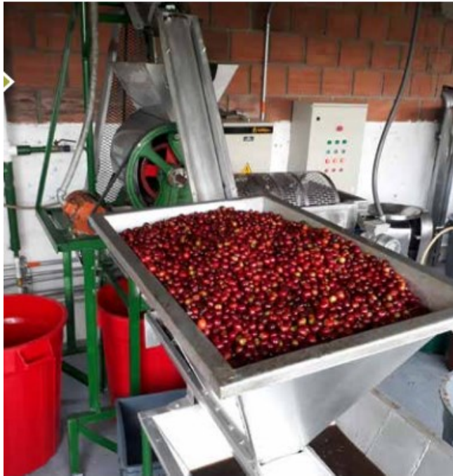
Figura 17. Despulpadora manual para separar la pulpa del grano
