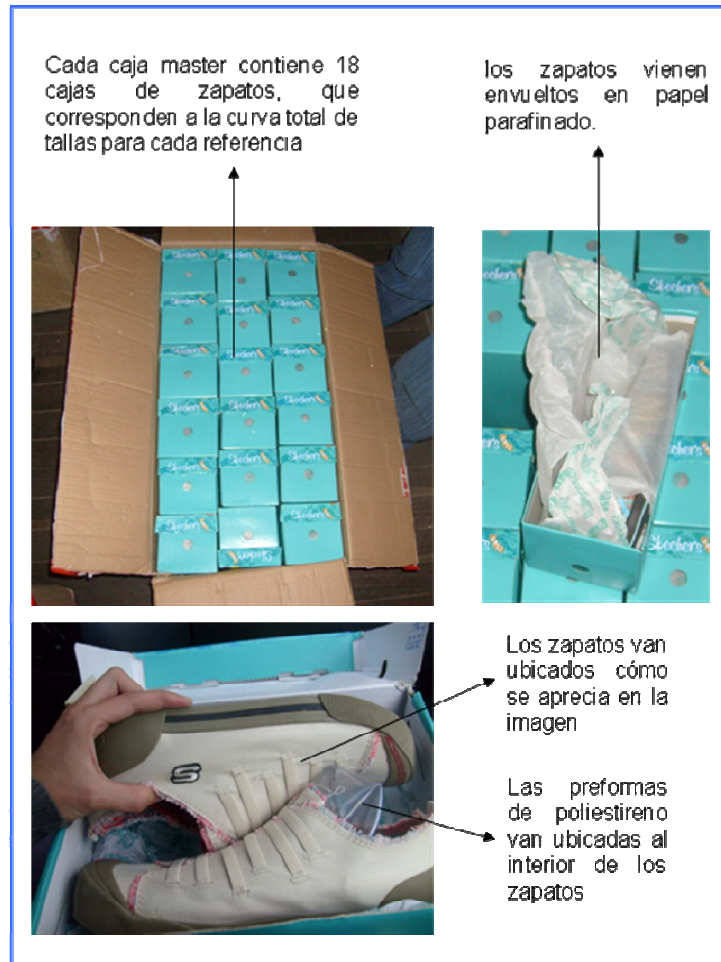
Figura 8. Distribución de los zapatos dentro de cada caja master y empaque y los componentes del empaque.
