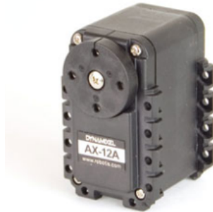
Fig. 9.15.: Dynamixel AX-12A actuator [99].
