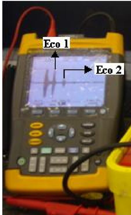
**Figura 37. Osciloscopio digital (con un ancho de banda de 20 kHz) para analizar la amplitud del voltaje dado por diferentes tipos de materiales evaluados en el laboratorio.**
