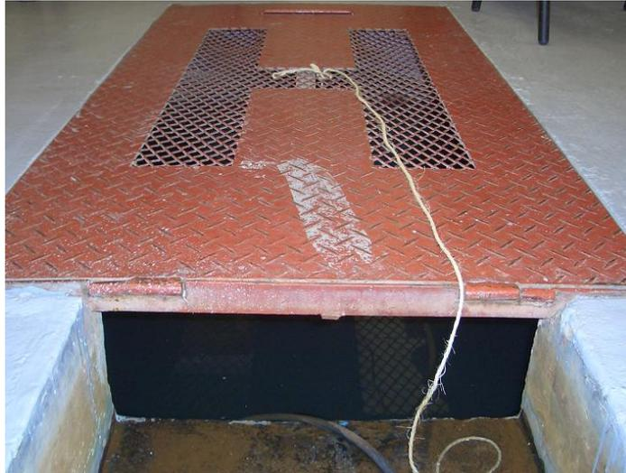
**Figura 17. Tanque donde se sumergió el transductor de 200 y 28 kHz, la cuerda que lo sostiene está ubicada en el centro de la tapa para asegurar que el patrón de radiación del transductor no interfiera en las paredes del tanque.**
