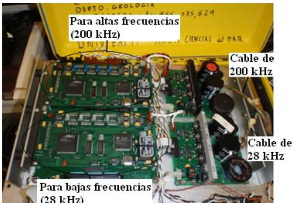
**Figura 34. Ecosonda Knudsen 320 BP con su respectivo hardware que permite hacer levantamiento batimétrico.**
