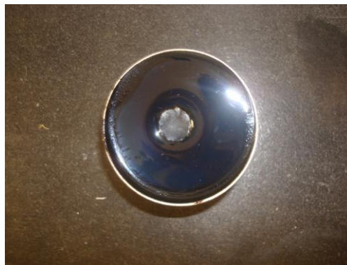
Figura 7. Deformación final del asfalto
