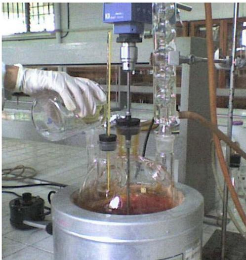
Después de adicionar el metóxido, se espera que la temperatura llegue a los 60°C y se deja por 90 minutos, para garantizar que se complete la reacción.
