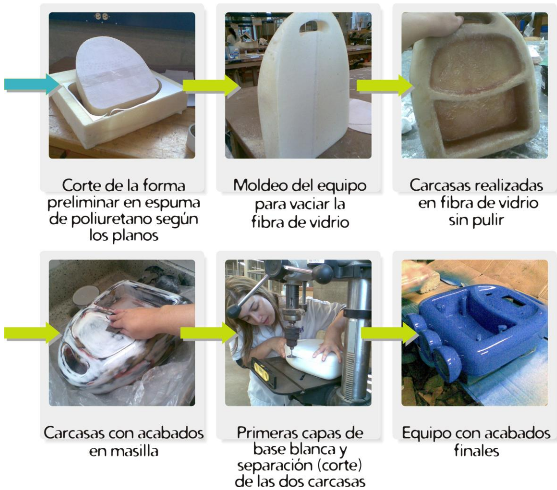
Figura 32: Proceso de construcción del modelo
