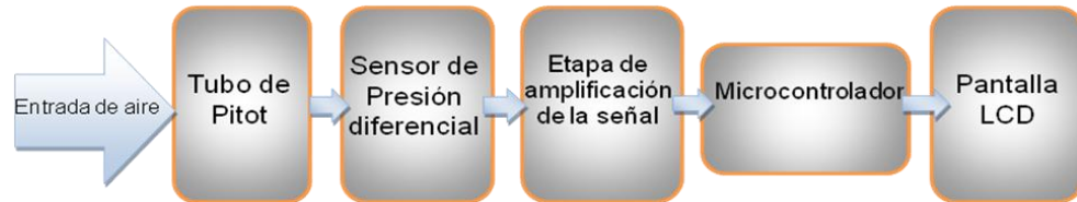
Figura 28: Disposición del nuevo medidor de FEM
